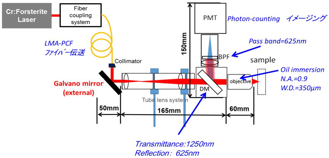
図 5-4 ハンドヘルド SHG 顕微鏡のセットアップ
