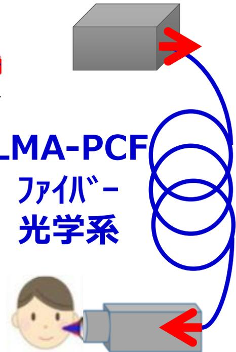
PCFファイバーを用いることで、分散を抑え、外部分散補償を行わなくとも最短パルス幅を維持したフェムトパルスレーザーを伝送することが可能であることを確認した。
