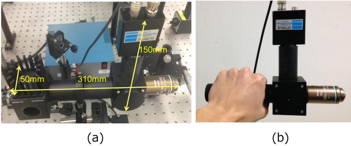
図 5-5 (a)ハンドヘルド SHG 顕微鏡の外観，サイズおよび，(b)プローブ部位の外観
